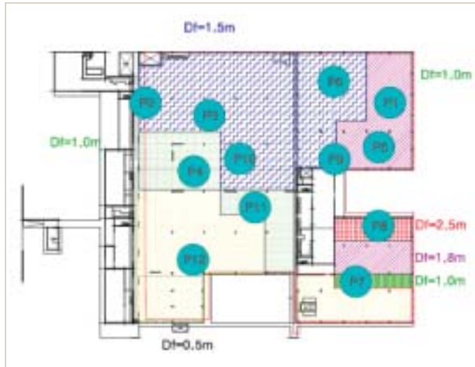
그림 3 CQC-2 치환심도 및 평판재하시험 위치
