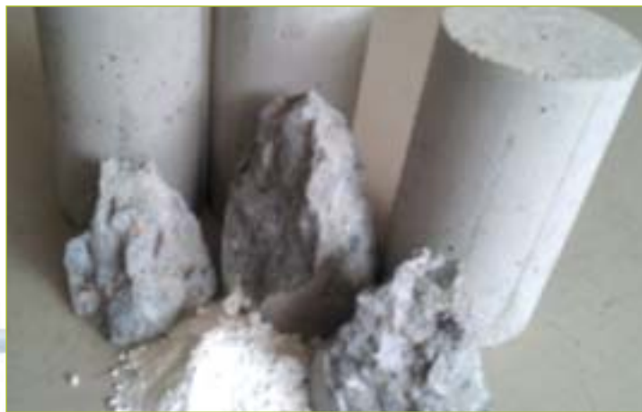
그림 5 DECO 2 공정 반응 부산물(CaCO 3 ) 및 이를 활용한 콘크리트
