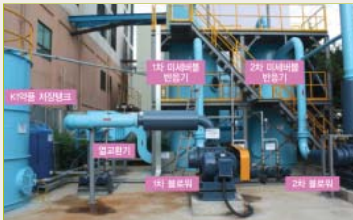
그림 3 DECO2 공정 Pilot Plant 전경 (10톤 CO 2 /일 처리규모)
